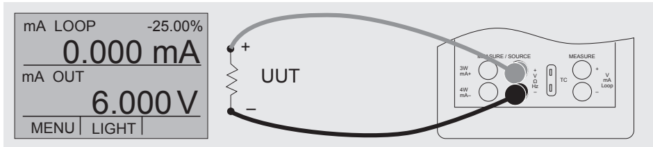
Anschlüsse für Spannung-, Frequenz- und Impulsausgabe
