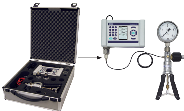
Базовый набор включает пневматическое устройство создания давления
