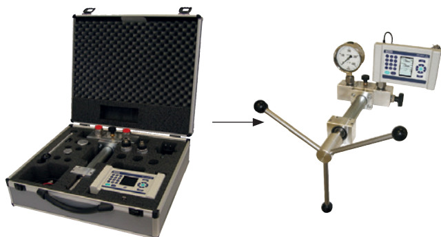
Базовый набор включает гидравлическое устройство создания давления
