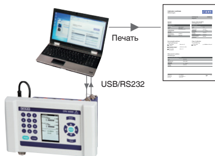
В) Передача данных в ПК и распечатка сертификата калибровки
