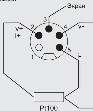
4-проводное подключение платинового термометра сопротивления
