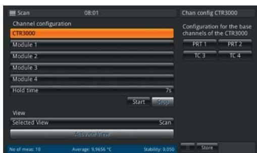
В этом меню пользователь может определить режим сканирования путем выбора каналов и времени удержания. Для активации сканирования нажмите кнопку пуска.
