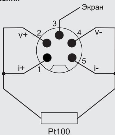
3-проводное подключение платинового термометра сопротивления
