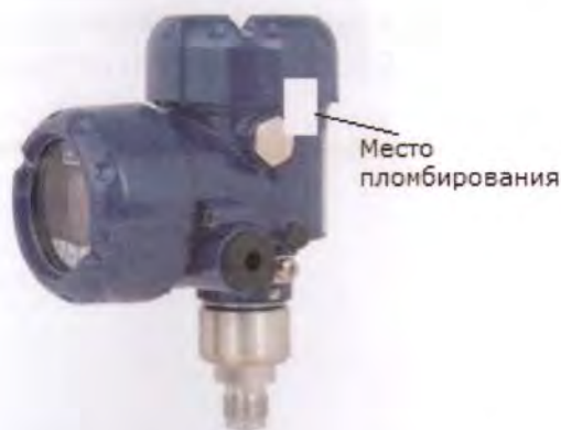
Рисунок 8 - Место пломбирования преобразователей давлений IPT-10, IPT-11
