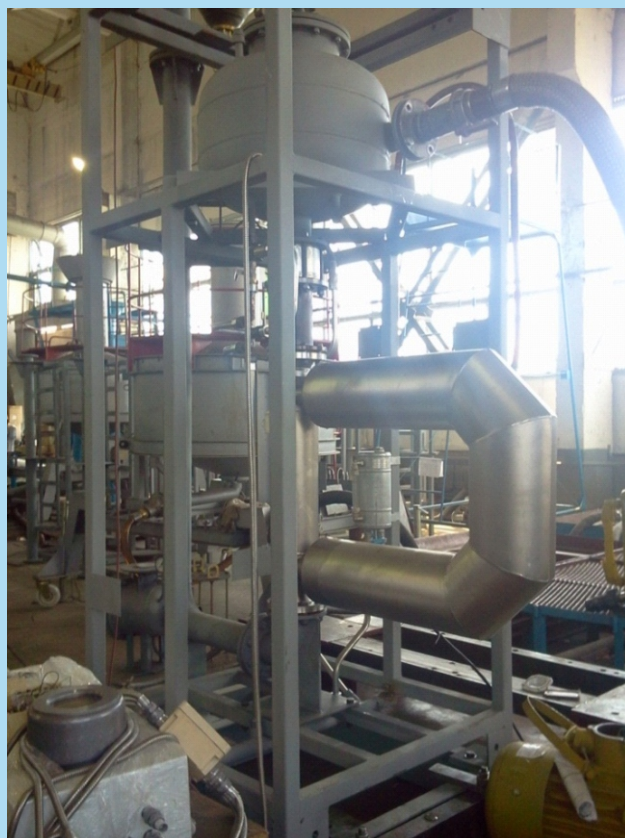
МИР-0.1 Ду80 Система налива дизельного топлива
